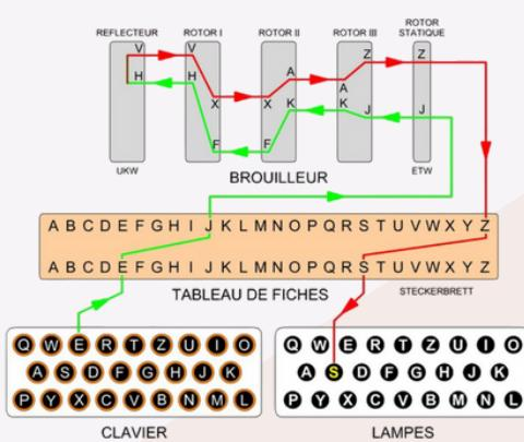
Lorsqu'on appuie sur une touche, la lettre chiffrée apparaît sur un panneau lumineux. Le résultat dépend de la position de trois pièces mobiles, appelées rotors, dont la position définit la configuration du réseau de substitution alphabétique. On peut en observer un exemple dans l'image adjacente.
